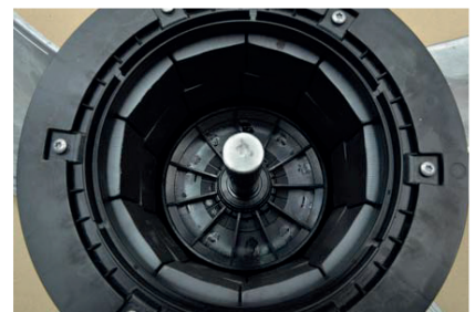
Ocelový rotor s umělohmotným chladičím kolem
