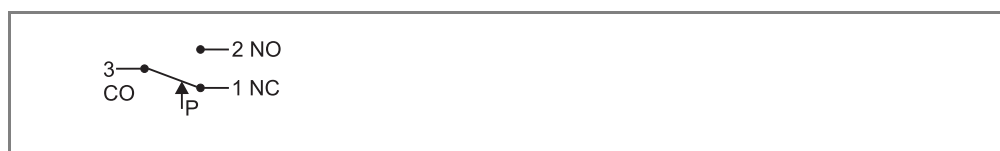
Obr. 5-8: Schéma zapojení spínače
