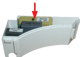
obr. 4 - instalace časového relé
