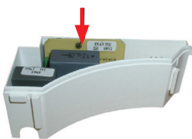
obr. 5 - instalace časového relé
