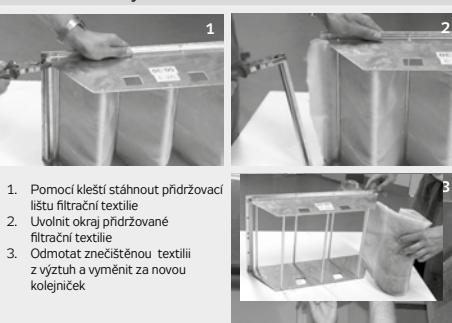
Obrázek 61 – výměna filtrační textilie
